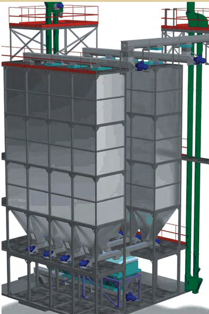
Рисунок 4. Собранный модуль основного дозирования зернового мучнистого сырья и шрота
