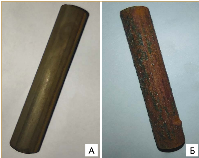
Рис. 1. Металлические цилиндры после теста коррозионной активности. А – Образец, помещенный в Ациланс. Б – Образец, помещенный в контрольный раствор без ингибиторов коррозии
